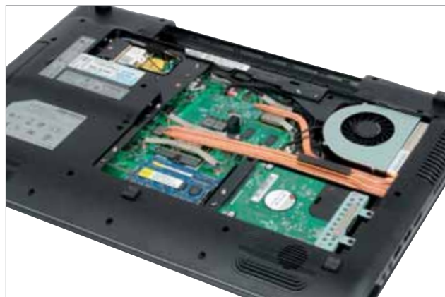
U tohoto notebooku po odšroubování spodního krytu snadno vyměníte dva paměťové moduly, pevný disk i Wi-Fi modul v delším Mini PCIe slotu
