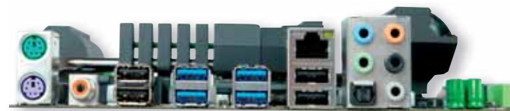
Čtveřice portů USB 3.0 pochází z jediného řídicího čipu, jehož dvě linky jsou rozděleny pomocí hubů VL810
