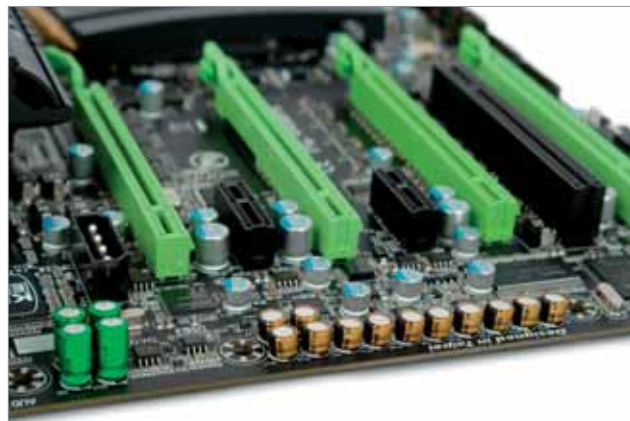
Použití speciálních audio kondenzátorů má svůj podíl na výsledné kvalitě zvuku produkovaného čipem Creative X-Fi 20K2
