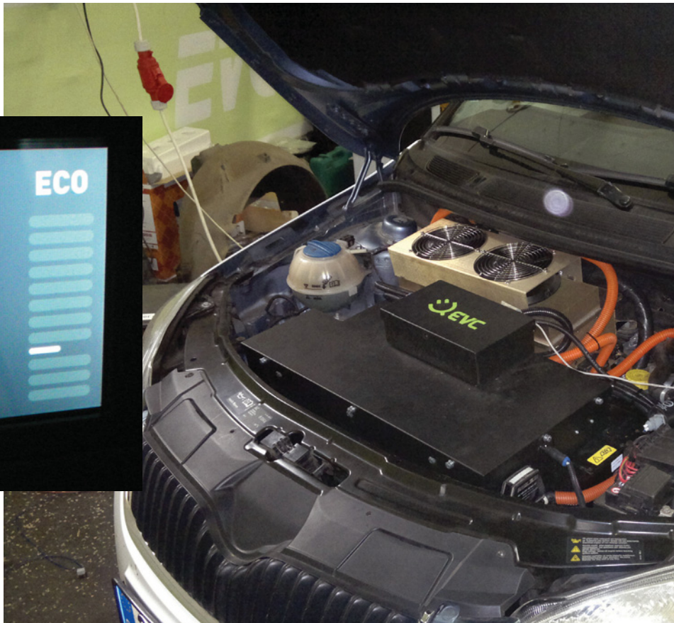
Přestavěná Škodovka: Místo spalovacího motoru přijde do motorového prostoru elektromotor a část baterií. Přidat se musí topení.
