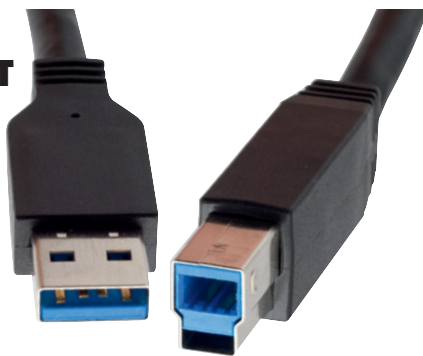
Konektor USB 3.0: Plochý konektor typu A (nalevo) je fyzicky stejně velký jako u verze USB 2.0, ale konektor typu B je kvůli přidáním vodičům větší.
