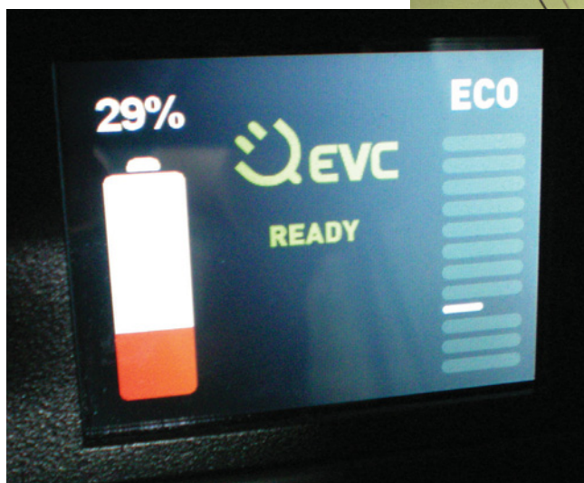
Stav: Displej ve fabii ukazuje stav akumulátoru a zatížení (případně rekuperaci) motoru. Data je možné přenášet i do smartphonu se systémem Android.
