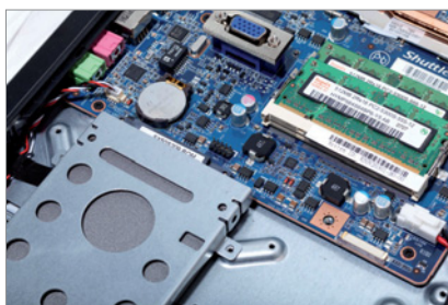
2 Shuttle disponuje dvojicí slotů pro paměťové moduly SO-DIMM DDR-2.
