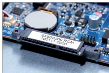
3 Do barebonu lze vložit 2,5" HDD/SSD disk s rozhraním SATA.
