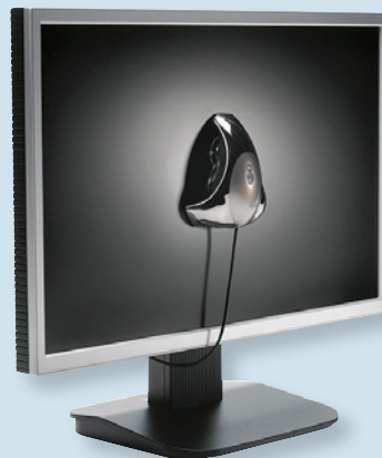
Kolorimetr: Typickým nástrojem pro kalibraci barev na hi-end monitoru je Spyder3 Pro.
