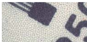
Elektronický inkoust Pearl Monochromatický displej zobrazuje data i bez napájení, ale nedokáže přenášet pohyblivé scény.
