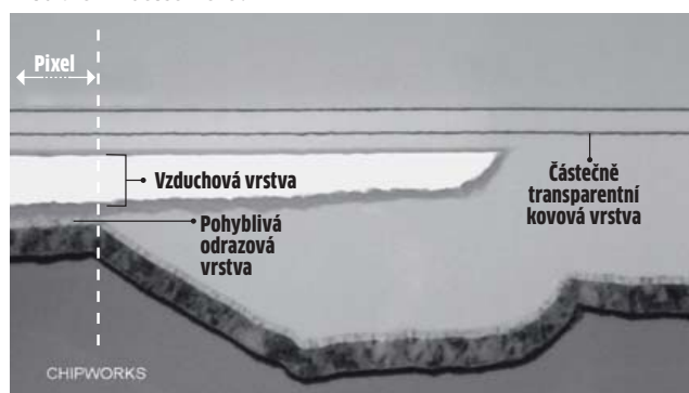
Pod mikroskopem Subpixely displeje Mirasol se skládají ze dvou vrstev, z nichž spodní je pohyblivá. V různých stavech zobrazuje buď černou, nebo červenou, modrou či zelenou barvu.
